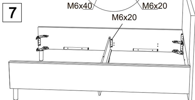
Фурнитура для установки подъемного механизма
