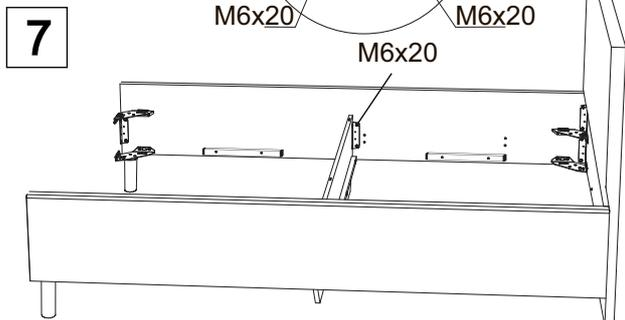
Фурнитура для установки подъемного механизма
